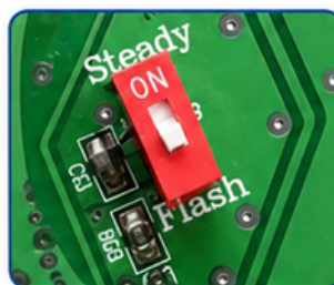
Interruptor DIP para seleccionar modo fijo o intermitente
